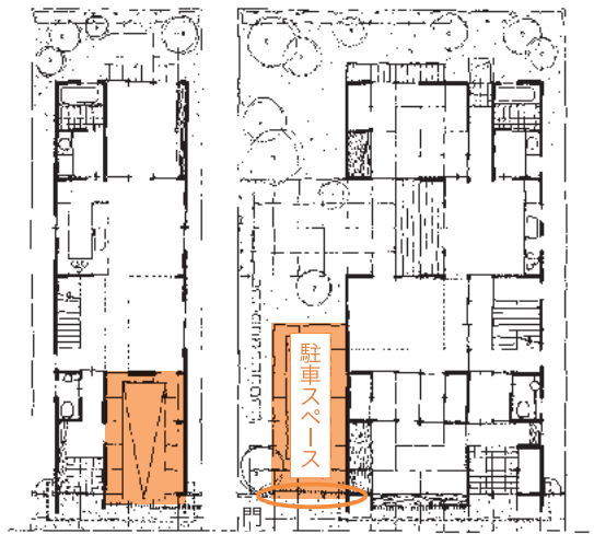
ビルトイン車庫の事例 駐車スペース前の門・塀の配置事例
