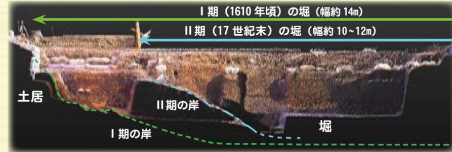
西外惣構断面の3次元画像と岸の変遷
